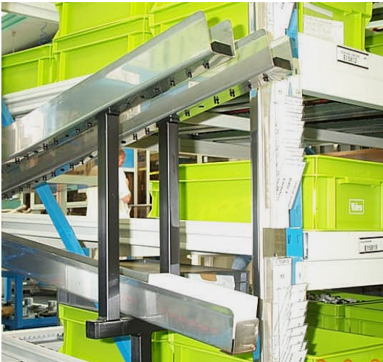
Boîtes à lot sur stockage dynamique en rack
