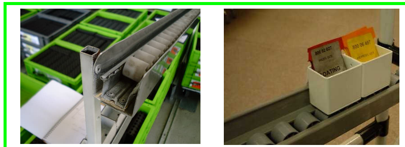
Rails FlexO diamètre 27 entraxe 32 pour recevoir les godets SPV 045 Les cartes sont visibles.
